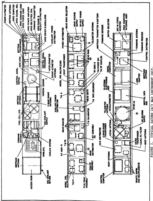
TYPICAL SATURN IB/V R&D INSTRUMENT UNIT.
