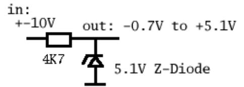
La tension doit être ajustée : c'est effectué grâce à une diode Zener qui limite les tensions négatives à  $-0.7V$  et les positifs à maximum  $+5.1$ .
