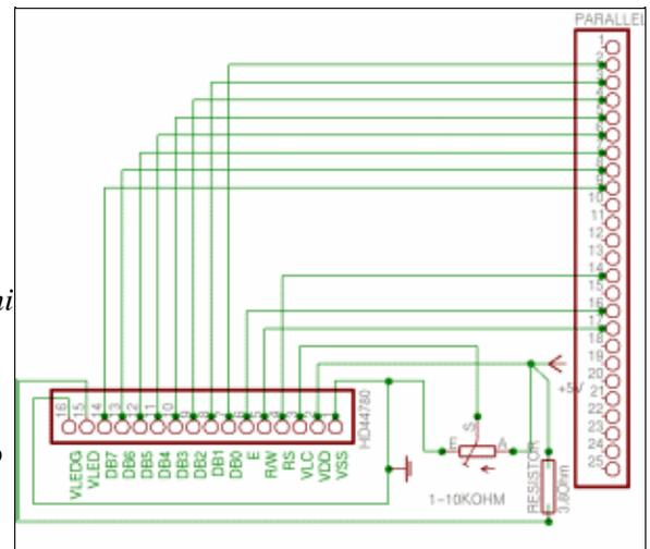
Per trovare dove connettere questi pin sulla porta parallela potete guardare lo schema sulla destra dove ho provato a renderlo il più chiaro possibile. Click sul diagramma per un'immagine più grande.
