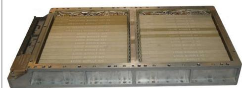
L'organizzazione a moduli sigillati dell'AGC garantisce affidabilità e permetteva di gestire anche gli aggiornamenti dell'hardware. I moduli contenenti le memorie erano posti in una sezione superiore che si collegava ai connettori centrali. Questo permetteva di "aggiornare" il software senza danneggiare l'integrità del resto del computer.
