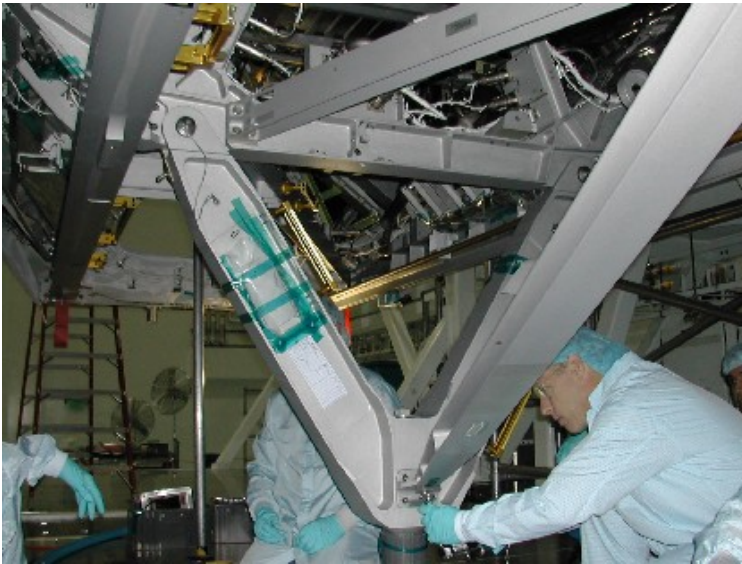
S3 Keel Pin/Drag Link – Launch Configuration
