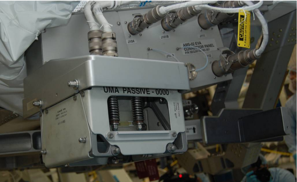
UMA Passive Connector and Electrical Pins
