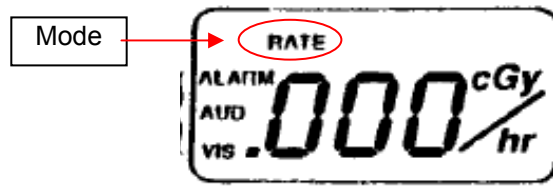
Figure 5-1b.- Default High Rate Dosimeter Display Mode.
