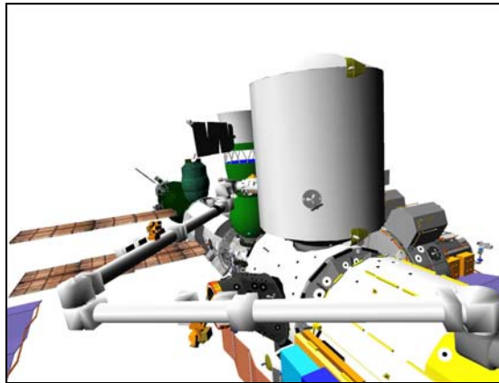
Figure 13.- MPLM Install Position (V10: SRMS Elbow: 140, 65).
